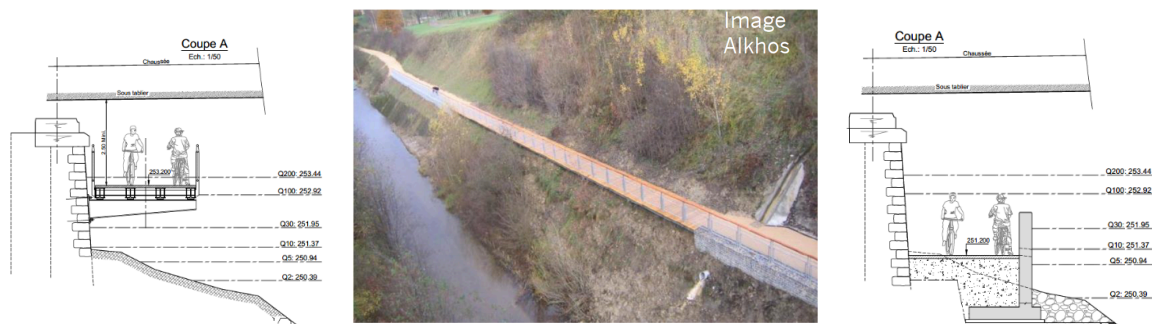
Figure 13. Présentation d'une passerelle en encorbellement sur les berges de l'Isère, avec des solutions consoles (à gauche) ou mur (à droite) - Vélo et Territoire
