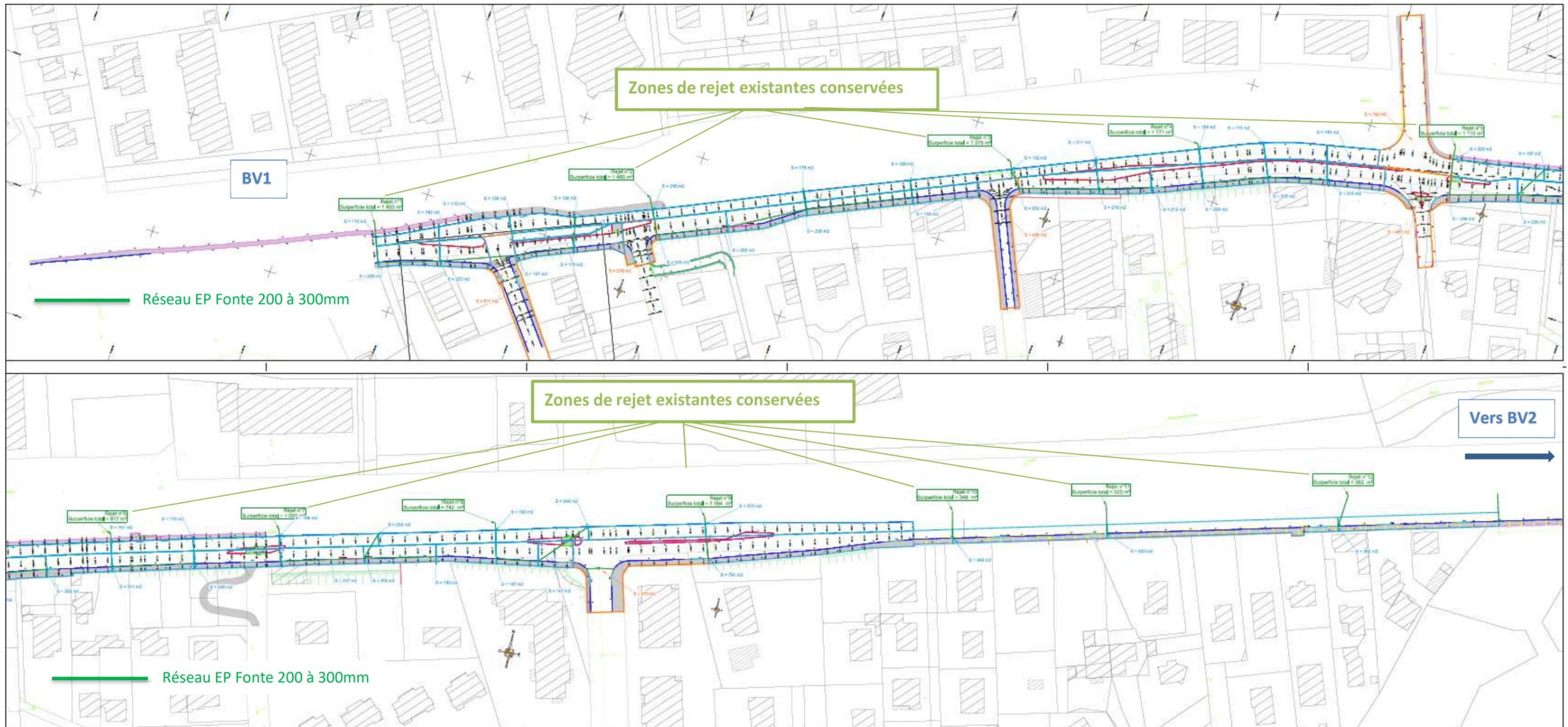
*Le bassin versant 1, secteur Ouest en aval du projet, et ses 12 point de rejets du réseau pluvial en plus des rejets diffus de voirie*
